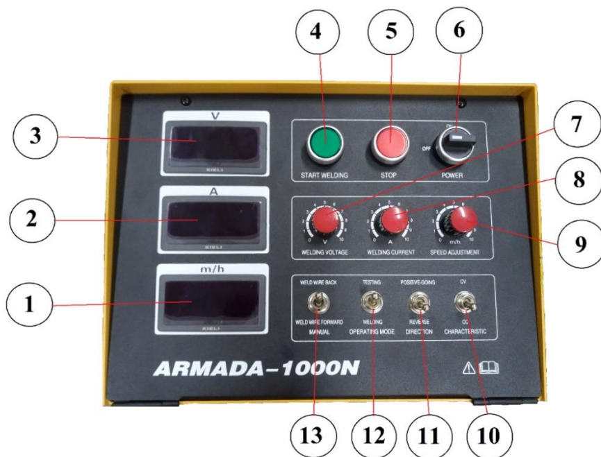
Рис. 6 Органы управления БУ сварочного трактора ARMADA.
