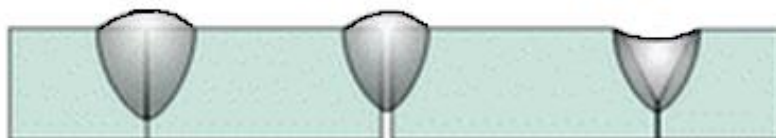
Рис. 17 Влияние подготовки кромок на форму шва.
