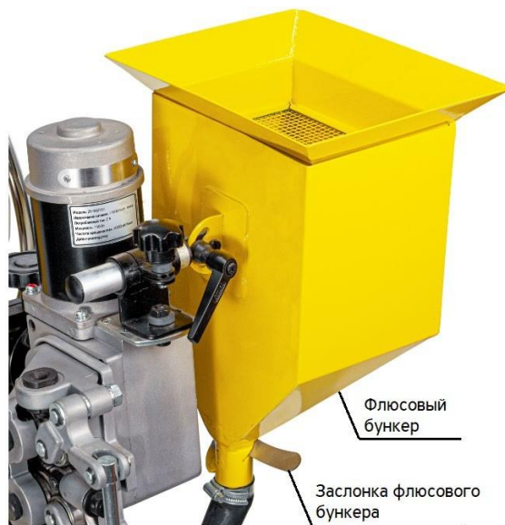
Рис. 12 Флюсовый бункер сварочного трактора ARMADA
