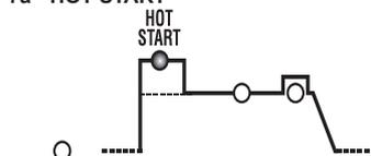
В режиме MMA соответствует начальной перегрузке по току "HOT START" (регулировка 0-100%) с указанием на дисплее процентного увеличения
